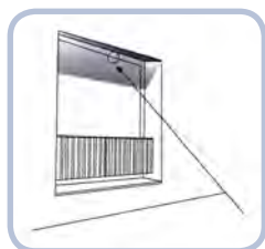
DETECÇÃO NO LIMITE DO EDIFÍCIO
